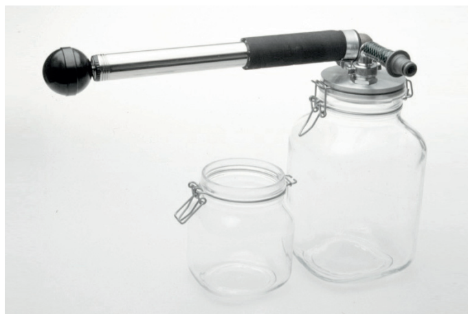
Abb. 2: Saugpumpe mit angeschlossenem 3 l fassendem Auffanggefäß (zur Entnahme größerer Volumina Pansensaft für Behandlungszwecke), 1 l fassendem Auffanggefäß (zur Entnahme von Pansensaftproben für Untersuchungszwecke).
